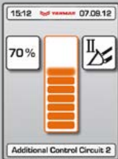
Einstellung der Oelmenge des dritten und vierten Kreises ueber das Display.
