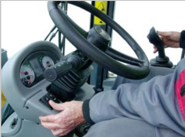
Einstellung der Oelmenge des dritten und vierten Kreises ueber das Display.
