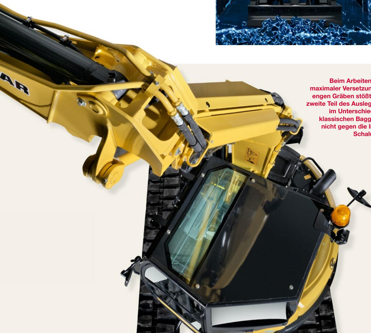
Beim Arbeiten mit maximaler Versetzung in engen Gräben stößt der zweite Teil des Auslegers, im Unterschied zu klassischen Baggern, nicht gegen die linke Schalung.
