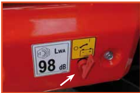
Batterieabklemmschlüssel vermeidet elektrische Verluste bei langen Stillstandzeiten.
