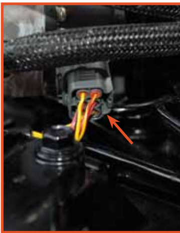
Wasserdichte elektrische Anschlüsse IP67
