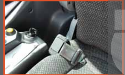
Sicherheitsgurt mit Aufrollautomatik.
