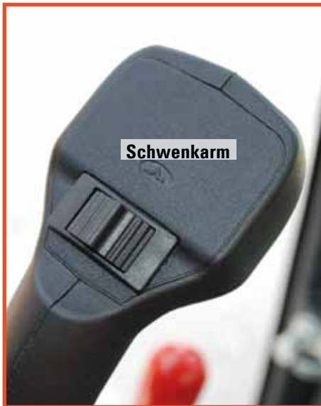
Feststellknopf für Hammerbetrieb unterm Joystick
