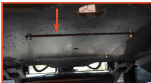
Abdeckplatte des Drehkranzes von unten.
