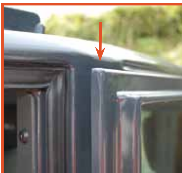
Feinschliffvollendete Schweißnähte der Kabinenprofile.
