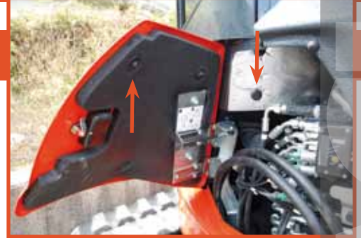
Innenbeschichtungen befestigt mittels Kunststoffpins (nicht nur geklebt).
