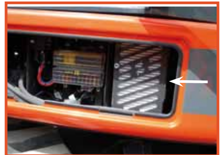
Leicht zugänglicher Haupt-Luftfilter.
