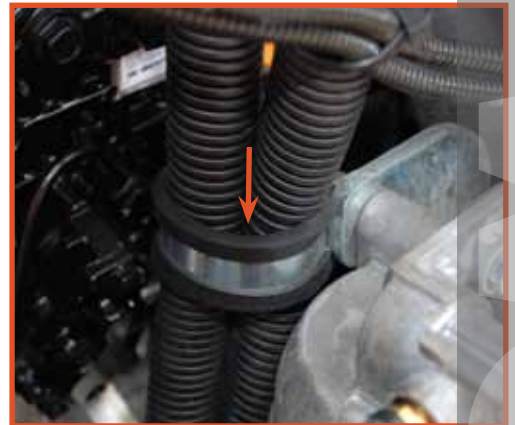
Anti-Verschleiß-Halterung aus Well-Hüllen-Material.
