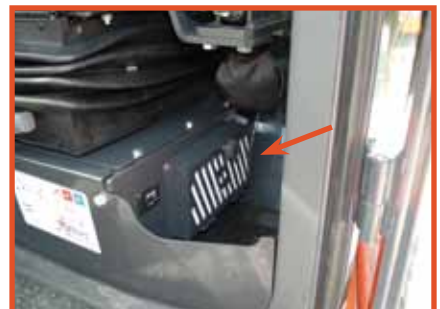
Artikel-Aufbewahrungsbehälter in der Kabine und Umluftfilter.
