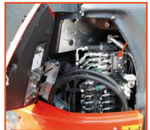
Kraftstoff-Nachfüllpumpe mit Auto-Stopp-Funktion beim Überlaufen und falls kein Kraftstoff mehr in der Kraftstoffquelle ist.
