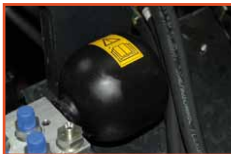
Der Akkumulator begünstigt die Druckentlastung der Zusatzhydraulik bei abgestelltem Motor.
