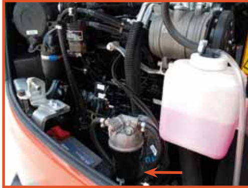
Sensor, der mittels Signallämpchen Wasser im Filter anzeigt.
