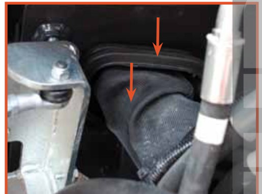
Schutzummantelung bei Schlauchdurchführung in Metallrahmen.
